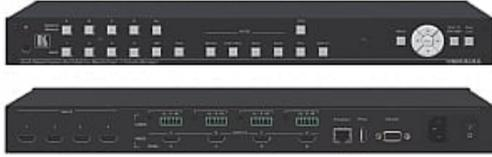
VSM-4X4A는 2x2 또는 1x4 비디오월 모드, 듀얼 모드, 쿼드 모드 멀티뷰 기능을 지원하는 HDMI 심리스 4입력 4출력 매트릭스 스위처입니다. 이 제품은 화면 전환시 딜레이 없는 클린컷을 지원하고, 딥컬러, 최대 8개의 오디오 채널을 포함한 HDMI 해상도를 지원하며 포트별 HDCP 및 EDID 설정을 지원합니다.
